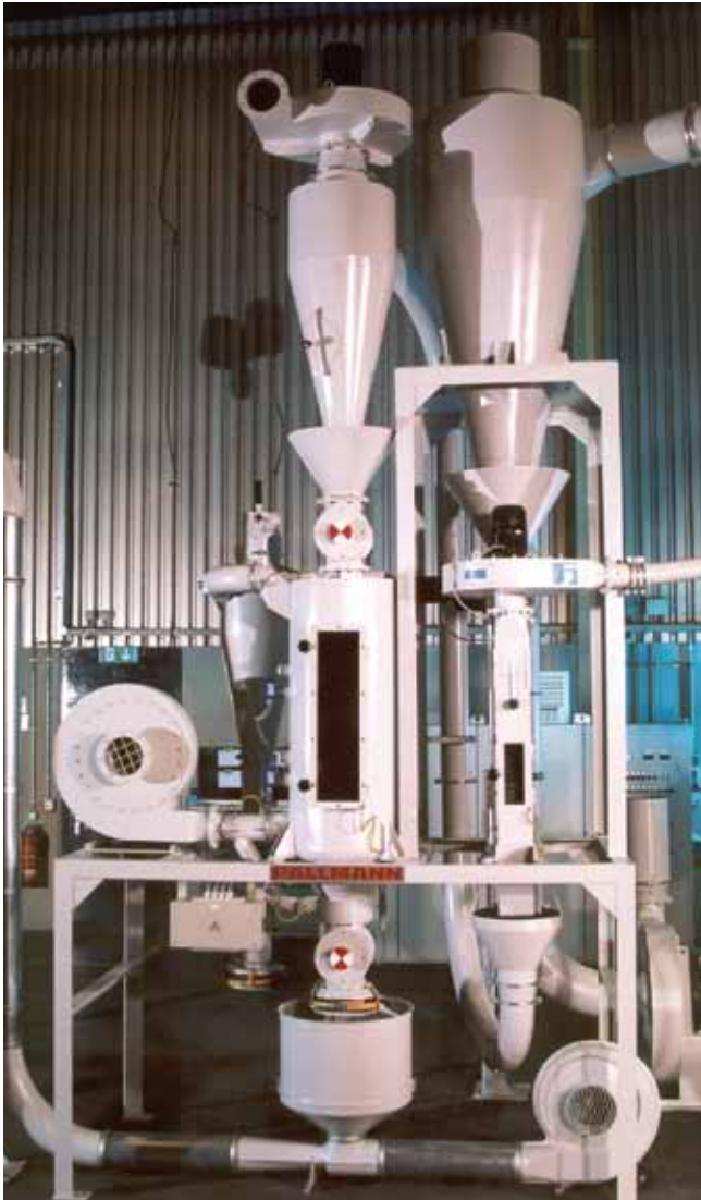
Granulatkühler und Sichteinheit
