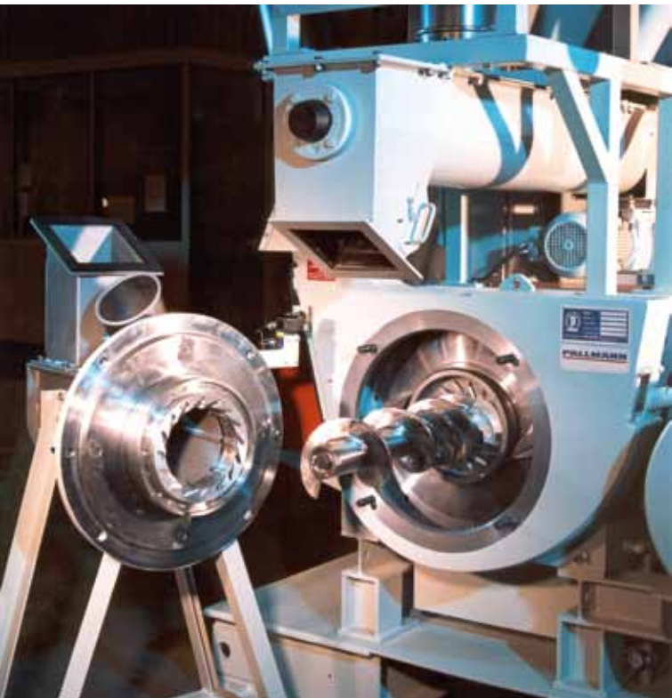
Agglomerierkammer des Plast-Agglomerators
